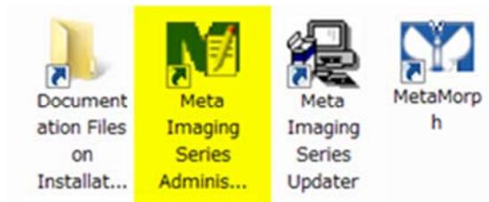
Meta Imaging Series Administrator では、制御しているカメラ、フィルターホイール、Zモータ、電動顕微鏡などのハードウェア設定、各種機能の表示・非表示設定、グループ作成などを行うことができます
