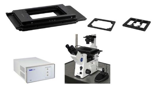
Olympus、Nikon、Zeiss 社製 顕微鏡対応高速電動ステージです。Olympus および、Nikon 用は取り付けブランケットを交換することで正立型/倒立型共にご使用いただけ、移動量も 110mm×75mm とウェルプレートに完全対応しています。ステージはジョイスティック操作の他、MetaMorph ソフトウェアからの制御により高い位置再現性を維持したまま、高速(最高 250mm/s)で走査が可能です。 薄型設計であるためステージ周りを有効利用でき、刺激系の実験にも最適なステージとなっています。 ※スライドガラス・ペトリディッシュに対応したホルダも別途ご用意しています。
