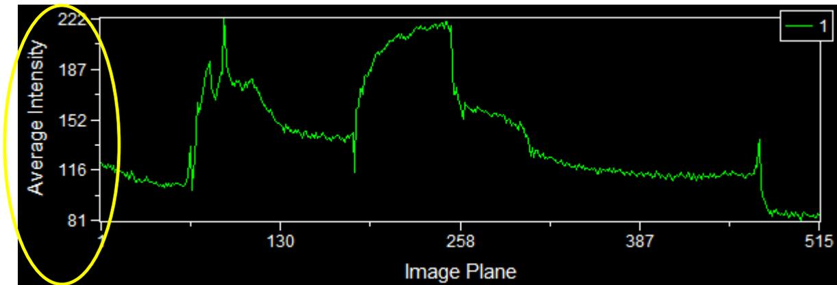
次に Journal で処理した画像で同じ領域を確認すると、各プレーンでの背景輝度減算を行っているため、より精度の高い処理がおこなえている事が確認できます。
