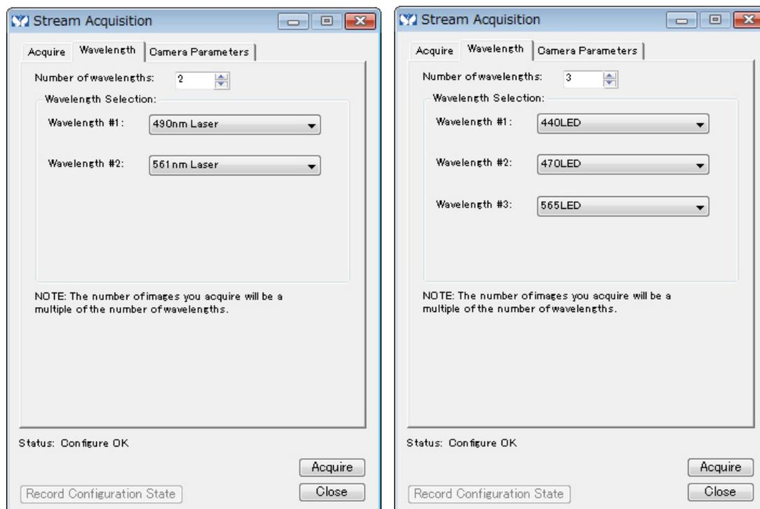
切替の速度はシャッターの開閉速度によりますが、 $\phi 6\text{mm}$  の小型シャッターの場合は数 msec、CoolLED は 10msec 以下で波長を切り替えながら撮影を行いますので、高速 2 波長タイムラプス、Z スキャンのユーザー様に最適です。
