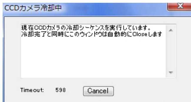
Show Message and Wait 機能の Time out 機能を併用することで、近年低温化が進む冷却 CCD カメラの冷却完了まで撮影できないようにする安全措置を施す事も可能です。
