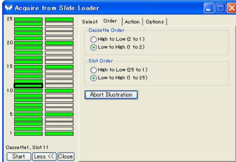
③スライドガラスを設置した際に Scan Slide や MDA を行えるように設定します。スライド交換時の対物レンズの退避設定も行うことができます。
