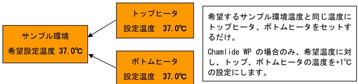
このように Chamlide インキュベータシステムは精度だけでなく、誰にでも簡単に温度設定、使用できる設計となっています。
