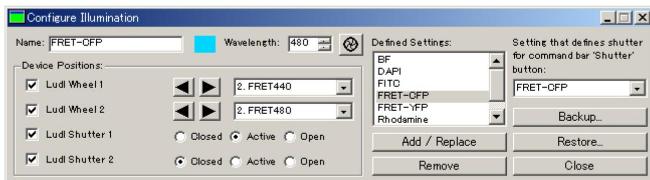
フィルターホイール内のフィルターポジション、シャッター開閉などを設定して、Name:に名称を記入して Add / Replace をクリックします。同様の操作で複数の Illumination Setting を作成します。Add / Replace をクリックした後に Defined Settings に登録されます。Backup をクリックしてファイルとして作成した Illumination Settings を保存することができます。
